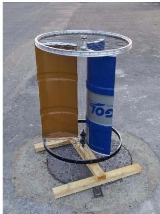
**1<sup>er</sup> essai de rotation après vissage sur support bois**
