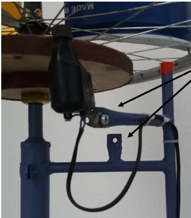
**2 points de fixation ont été prévus sur le bras pour pouvoir déplacer la dynamo et comparer la production d'électricité selon le diamètre du disque utilisé**
