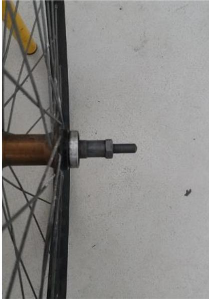
La tige filetée du moyeu permet le maintien sur le mât.
