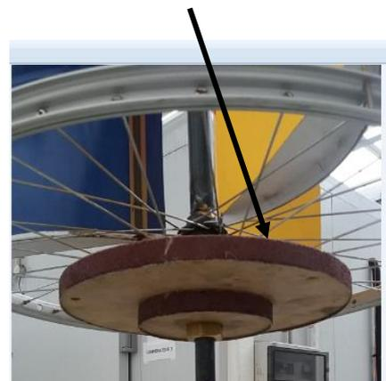
La pose de 2 disques de diam différents nous permet de comparer la production d'électricité fournie selon la position de la dynamo
