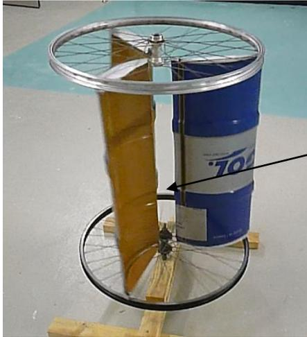
Pour assurer l'aplomb il est nécessaire de mettre un tube de maintien entre les 2 axes des roues
