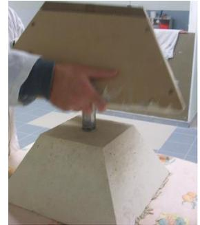
Car le bois est un matériau facile à couper, à assembler puis à décoffrer, qu'il est généralement utilisé pour de nombreux coffrages en maçonnerie. La fabrication d'un coffrage sera réalisable en atelier Bois
