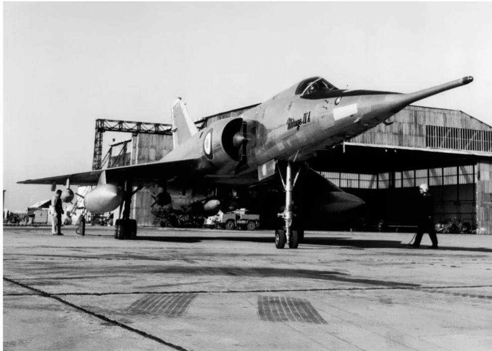
Le Mirage IV A n° 1 en septembre 1965 à Istres avant un vol d'essais avec des bidons pendulaires de 2 500 litres et huit bombes classiques de 400 kg.
