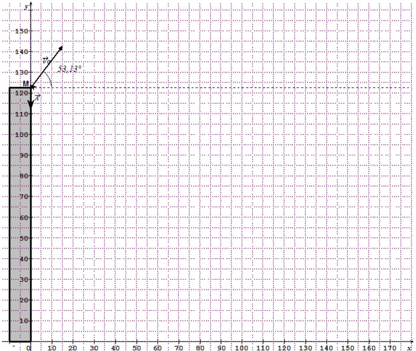
On a photographié et relevé dans un tableau la position du point mobile M ( $x(t); y(t)$ ) à différents instants notés  $t$ .
