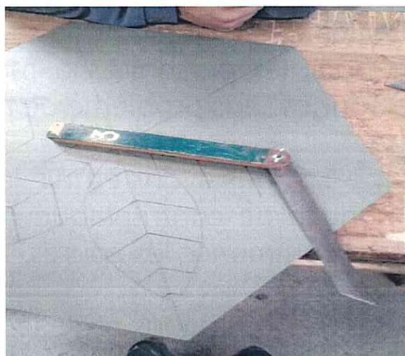
Pour réaliser les premiers tracés, j'ai utilisé une équerre que j'ai positionnée à chaque extrémité de l'hexagone pour obtenir six droites afin de déterminer le centre de chaque motif à réaliser.
