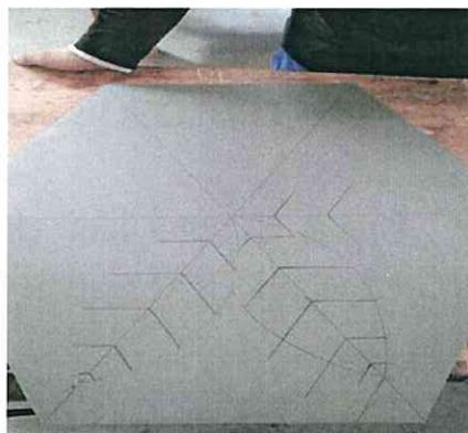
Pour pouvoir mettre les tracés des nervures à la bonne longueur, un gabarit qui permet de réaliser la courbe d'une feuille a été fabriqué, ce qui permettra de marquer la fin du tracé pour ensuite pouvoir réaliser les rainures à l'affleureuse.
