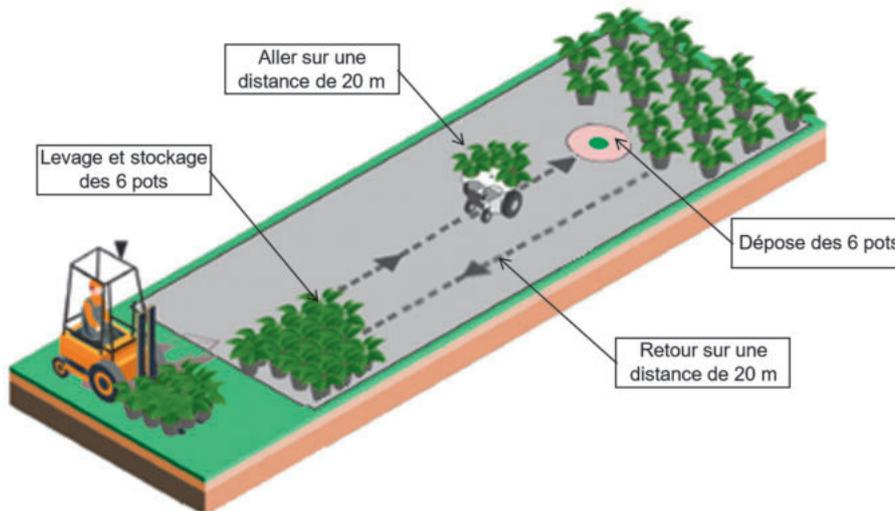
Figure 7 : opération de distançage de plantes en pot
