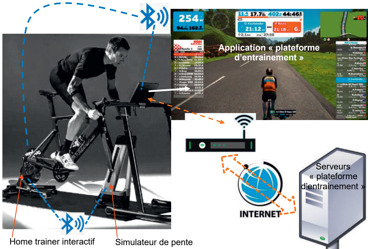
Figure 4 : échange d'informations au sein de « l'écosystème » du simulateur de pente.
