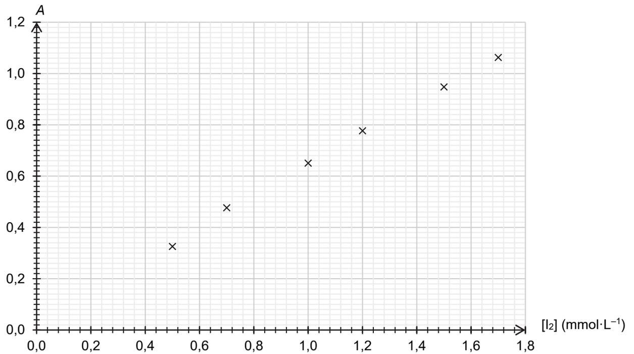
Figure A1. Évolution de l'absorbance de solutions étalon de diode en fonction de la concentration
