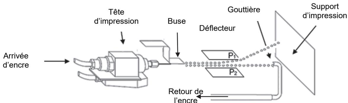
Figure 1. Schéma de principe de l'imprimante à jet d'encre continu dévié (d'après le site [timis.fr](http://timis.fr))
