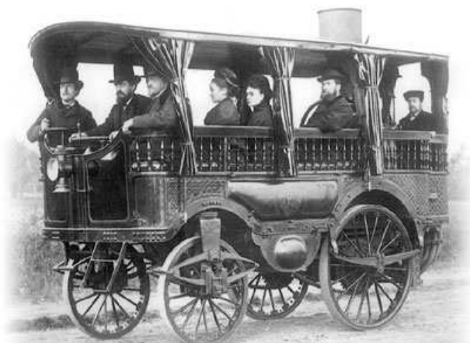
Amédée Bollée et ses deux frères à bord de L'Obéissante en 1873. Devant au centre, Amédée est le « conducteur » alors que le « chauffeur » est à l'arrière.
