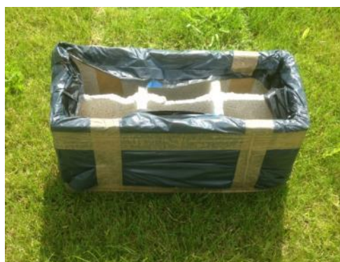
Le parpaing emballé dans un sac poubelle pour le rendre imperméable mais bien serré pour ne pas tricher en changeant le volume.
