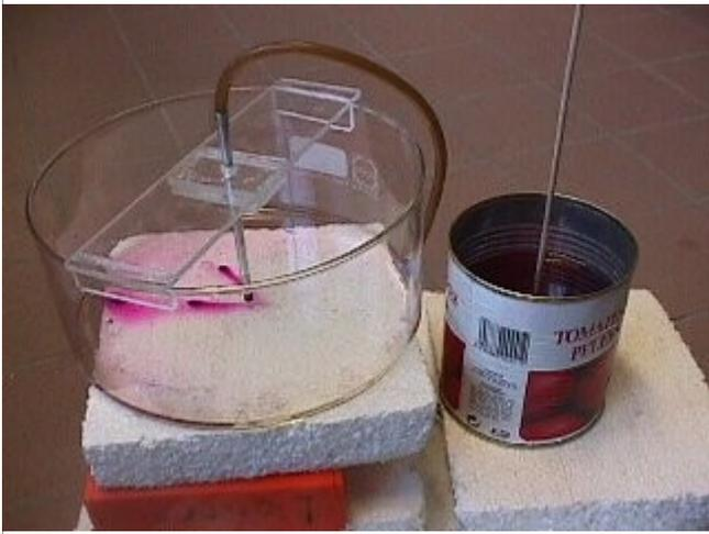
La différence de niveau entre le cristalliseur et la boîte doit être de 5 cm au moins.
