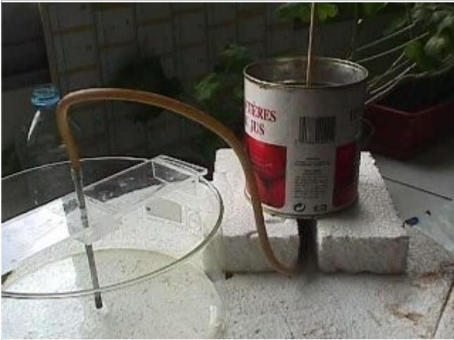
Les cales laissent passer le tuyau de siphonnage. Le pont en "Plexiglas" s'appuie sur les deux bords d'un cristalliseur à parois minces.
