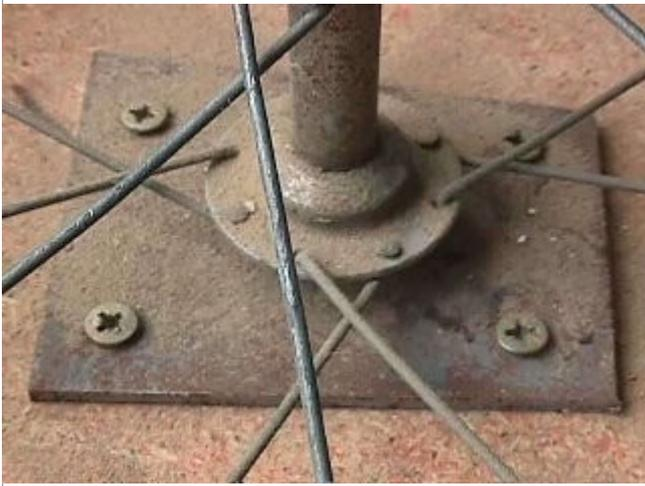
Plaque métallique, percée aux diamètres voulus. Elle permet de fixer la roue de bicyclette d'enfant par son axe en utilisant l'écrou d'origine (invisible ici)
