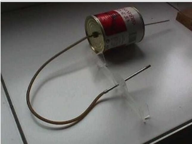
Un embout pour tube souple est fixé au fond de la boîte de conserve (accessoires pour aquarium ou pour respiromètre). Le tube souple est raccordé à l'autre bout à un tube d'aluminium de 5 mm de diamètre fixé dans une plaque de "Plexiglas".
