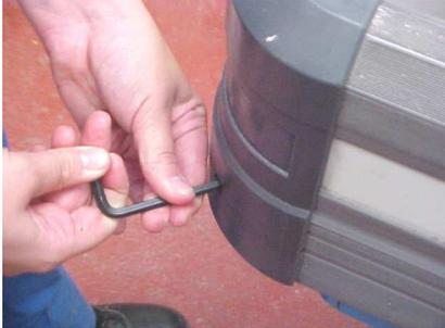
**1** – Dévissez les vis CHC M6 – 60 des embouts à l'aide d'une clé six pans mâle.
