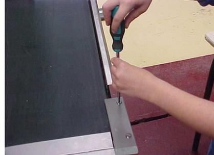
**2** – Démontez les vis FF M6 – 20 à l'aide d'un tournevis à lame plate.
