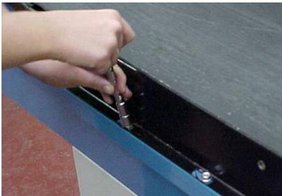
**5** - Dévissez les vis H M6 - 10 de fixation du tapis sur le bâti.
