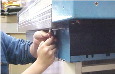
**3** - Démontez les vis à tôles Ø 4 à l'aide d'une clé à pipe de 7.
