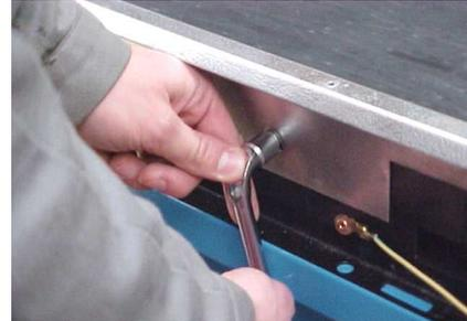
**4** - Dévissez les vis H M6 - 10 de la règle de guidage à l'aide d'une clé à pipe de 10.
