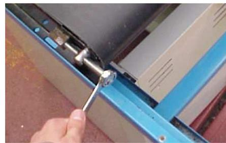
**6** – Desserrer les deux vis H M10 - 100 à l'aide d'une clé mixte de 17
