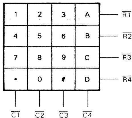
Quand on appuie sur une touche, on active les deux broches correspondantes du composant en les reliant à la masse. ( appui sur la touche 1  $\Rightarrow$   $\overline{R1}$  et  $\overline{C1}$  à la masse )
