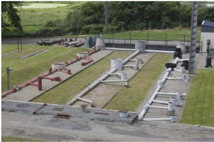
Réseaux non-visibles de diamètres différents inférieurs à 600 mm, de matériaux différents, comportant : bouches d'égout à avaloirs ; regards de visite ; coudes, tés ; chambre à sable avec dégrillage ; poste de relevage avec panier dégrilleur ; déversoir d'orage...
