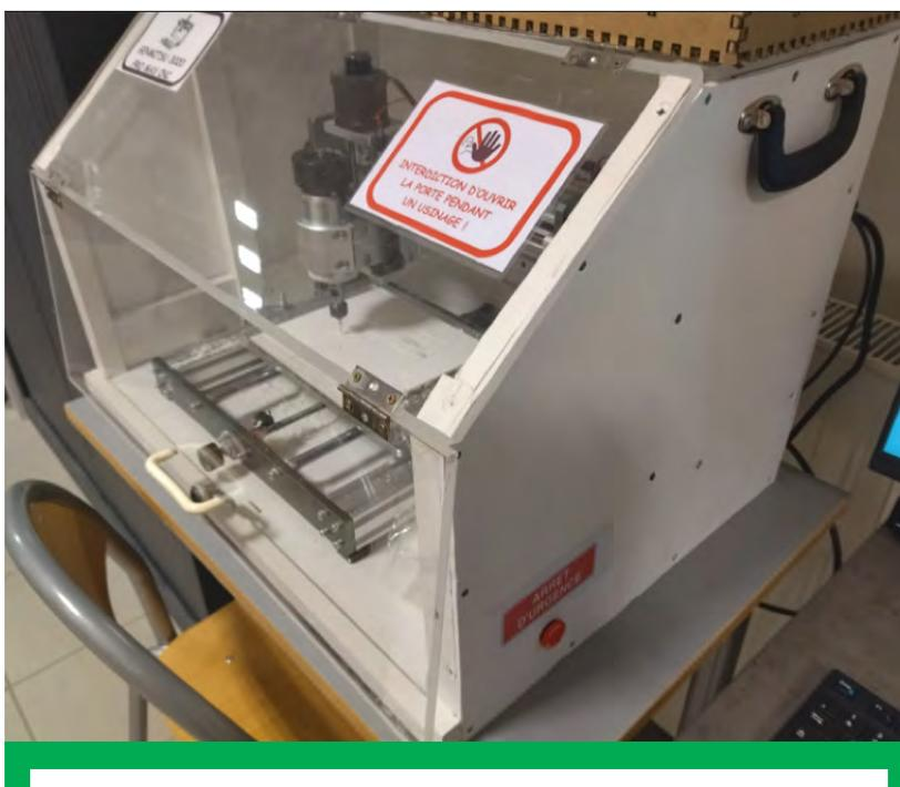
*Carter de sécurité, équipé d'un verrouillage et d'un arrêt d'urgence, réalisé par le professeur. Dans le cas d'une imprimante 3D, on pourrait y ajouter un dispositif d'aspiration et de filtrage des COV.
