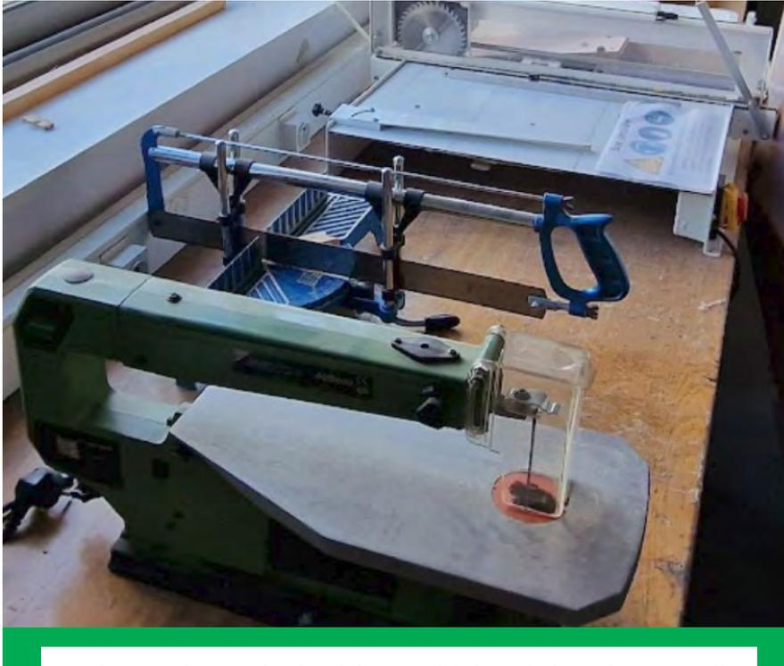
*De haut en bas : Scie circulaire cartésienne, scie à onglet manuelle et scie à chantourner cartésienne. Tous ces matériels sont utilisables par des élèves.*
