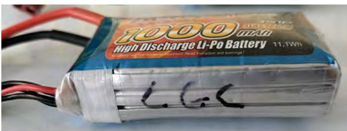
Cette batterie est gonflée, elle doit être considérée endommagée et présente un risque d'incendie. Elle doit être déchargée à l'aide d'un appareil adapté puis mise au rebut dans un endroit spécifique.
