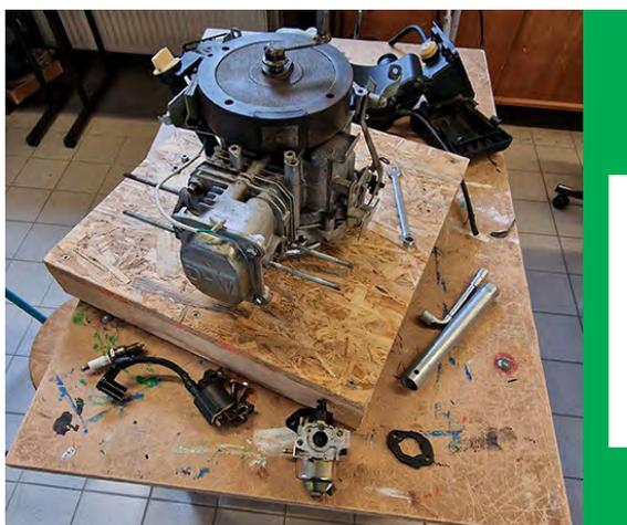
*Activité d'investigation et d'analyse d'un système énergétique, par le démontage, l'analyse et le remontage par des élèves de 3<sup>e</sup> d'un moteur thermique de tondeuse à gazon, préalablement préparé et nettoyé par le professeur. Activité réalisée dans une série de séances tournantes, car un seul moteur est disponible pour cette activité dans le laboratoire. Collège Pierre et Marie Curie au Pellerin.*
