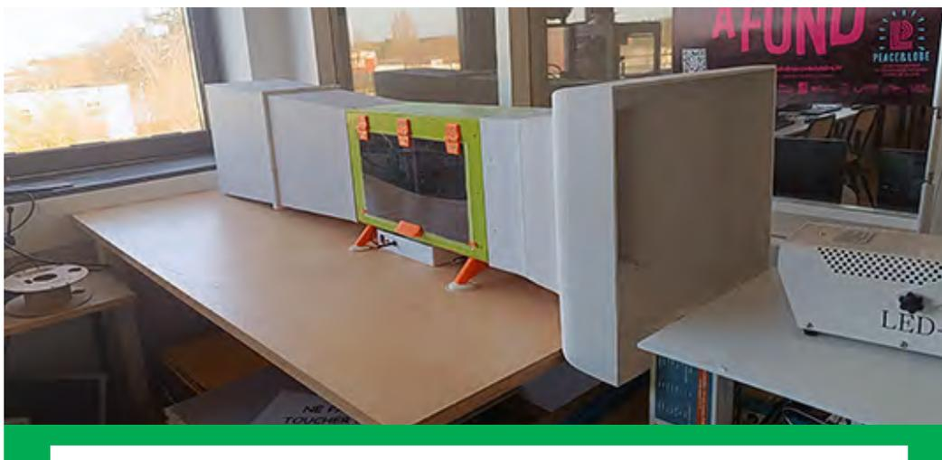
*Banc de test en soufflerie, conçu par l'enseignant, utilisé avec une machine à fumée et projecteur utilisé dans le cadre de la préparation au concours « Course en cours ».*
