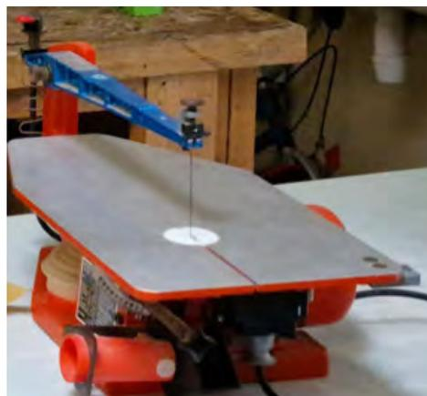
Scie à chantourner si elle n'est pas pourvue d'un carter de protection (peut être utilisée par des élèves si présence d'un carter de protection de la lame)
