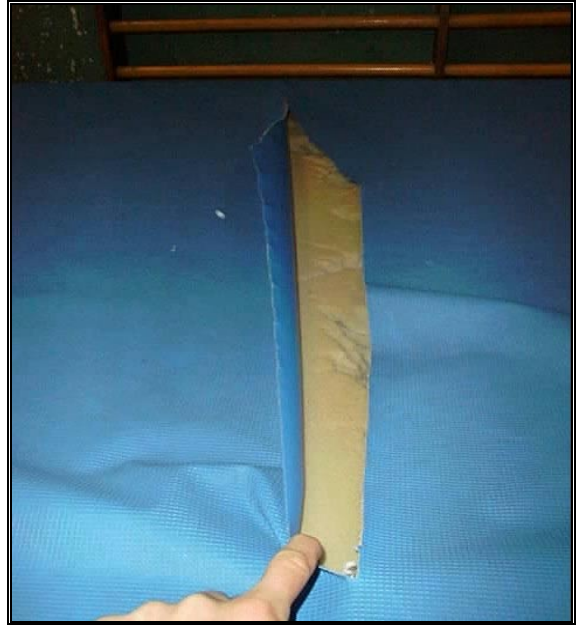
Housse déchirée, face supérieure
