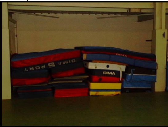
Stockage en tas horizontal : Risque de déformation des mousses
