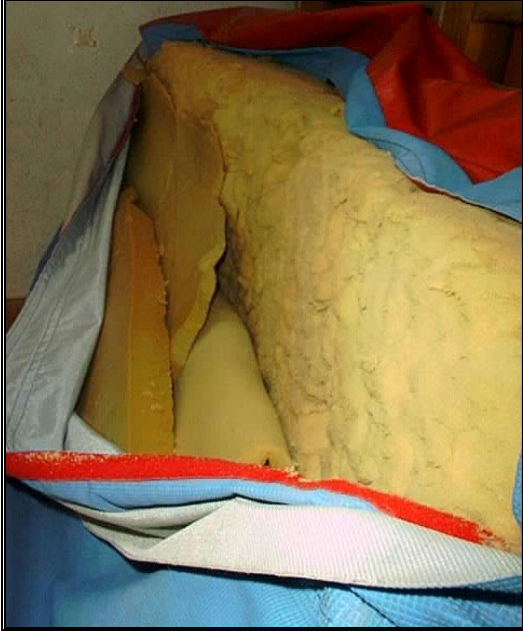
Mousse cassée, déformation permanente
