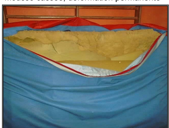
Mousse cassée, déformation permanente
