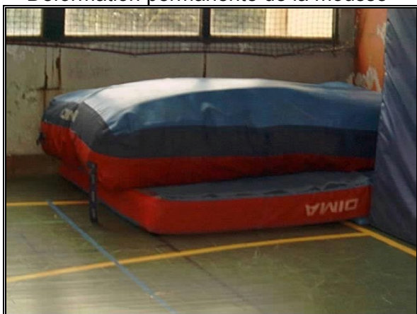
Déformation permanente de la mousse
