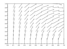
La deuxième possibilité est la commande fchamp(f,t0,x,y) qui trace le champ de vecteurs associé à l'équation différentielle y'(t) = f(t,y(t)) au temps  $t_0$ . Attention : la fonction f doit avoir comme variables d'entrée t et y, même si elle ne dépend pas de t. Voici un exemple où sont superposés le champ de vecteurs et quelques trajectoires de l'équation différentielle.
