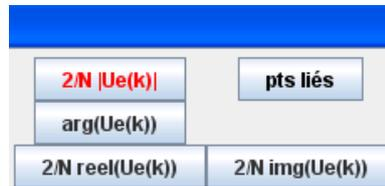
$2/N |Ue(k)|$  représente le spectre de module  $|Ue(k)|$  de la transformée de Fourier discrète multiplié par  $2/N$ . C'est donc le spectre tel qu'il est utilisé en Physique appliquée.
