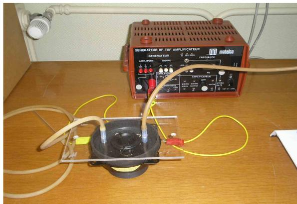
Les ondes circulaires sont générées par un tube de verre (morceau de pipette simple) relié à une cartouche d'encre par l'intermédiaire d'un tuyau souple (feuille anglaise). Prévoir 2 dispositifs identiques.
