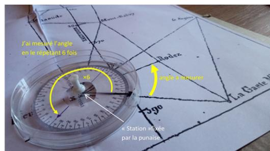
Les sources d'erreurs de mesure avec le cercle répétiteur simplifié sont nombreuses. L'axe de rotation doit être parfaitement centré et dépourvu de jeu. On peut atteindre une incertitude inférieure à 0,5° en se rapprochant des conditions de répétabilité et de reproductibilité suivantes :
