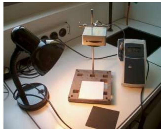
Pour chacun des appareils il faut commencer la manipulation par la sélection du diaphragme (grande ouverture) et du filtre (IR). On réalise ensuite un étalonnage. La lampe étant allumée, on veillera à ce que les distances lampe-échantillon et échantillon-radiomètre ne varient pas pendant l'étalonnage et la mesure.
