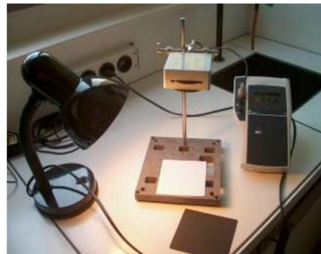
Il faut commencer la manipulation par la sélection du diaphragme (grande ouverture) et du filtre (V, R ou IR). On réalise ensuite un étalonnage. La source lumineuse étant allumée, on veillera à ce que les distances lampe-échantillon et échantillon-radiomètre ne varient pas pendant l'étalonnage et la mesure.
