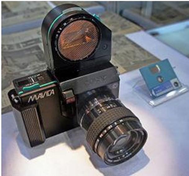
japonaise l'a doté d'un capteur CCD de 279.300 pixels et d'un système de stockage sur disquettes pouvant accueillir 50 images.
