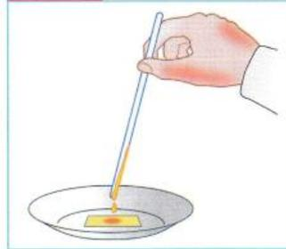
■ Découper un morceau de papier pH et le placer dans une coupelle. Sur le papier, déposer une goutte de la solution prélevée.
